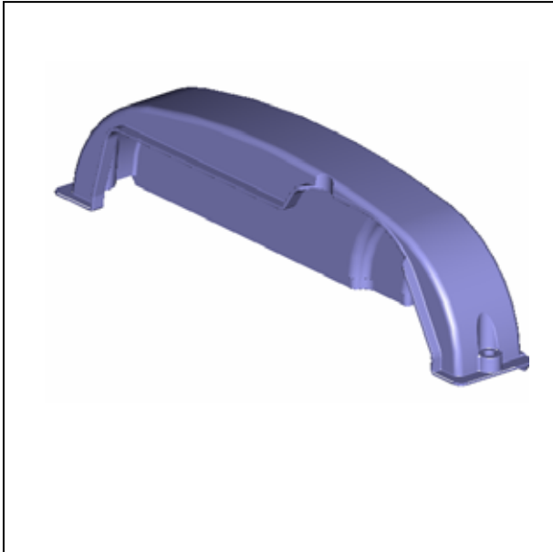
۱۰- قاب تسمه تایمینگ فوقانی را باز نمائید. (۲ عدد پیچ) (آچار E8)
