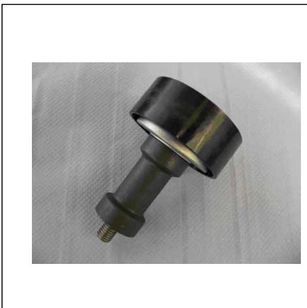
۱۲- هرزگرد تسمه (۲) (پائین - وسط) را باز کنید. (۱ عدد پیچ) (آچار بکس ۱۶)
